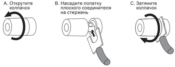
**ВНИМАНИЕ:** Убедитесь, что лопатки плоских соединителей (+) и (-) не касаются друг друга или других клемм. В противном случае может произойти короткое замыкание, которое может повредить ресивер или усилитель.
