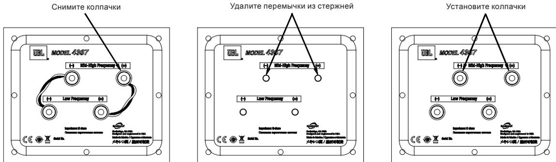
Если вы двумя проводами подключаете колонки к одному стерео-усилителю, выполняйте подключение в соответствии с рисунком ниже.
