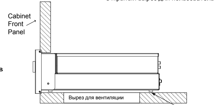
Вид сбоку на MCD600 в специальном шкафу
