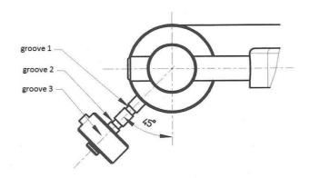
Отрегулируйте компенсацию скатывающей силы, разместив груз на соответствующей канавке механизма для компенсации скатывающей силы. Компенсацию скатывающей силы необходимо отрегулировать согласно прижимной силе следующим образом:
