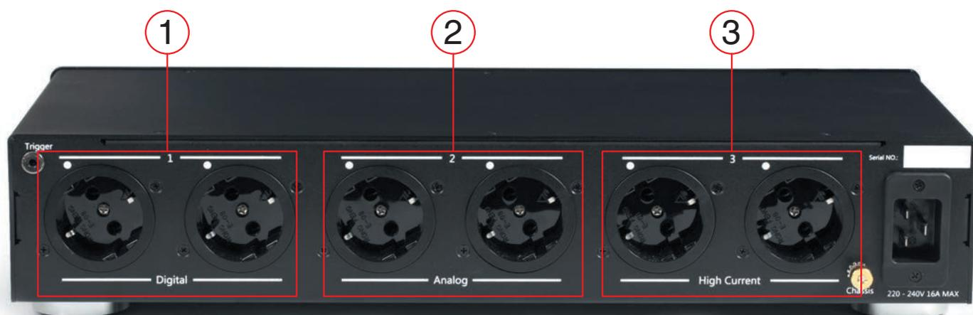
\* Градация приблизительная, при наличии данных о типе блока питания рекомендуем разбивать их следующим образом: для розеток Digital – импульсный блок питания, для розеток Analogue – трансформаторный блок питания. Информация носит рекомендательный характер, для достижения оптимального качества звучания рекомендуется попробовать разные комбинации подключений. Каждая розетка рассчитана на номинальный ток.
