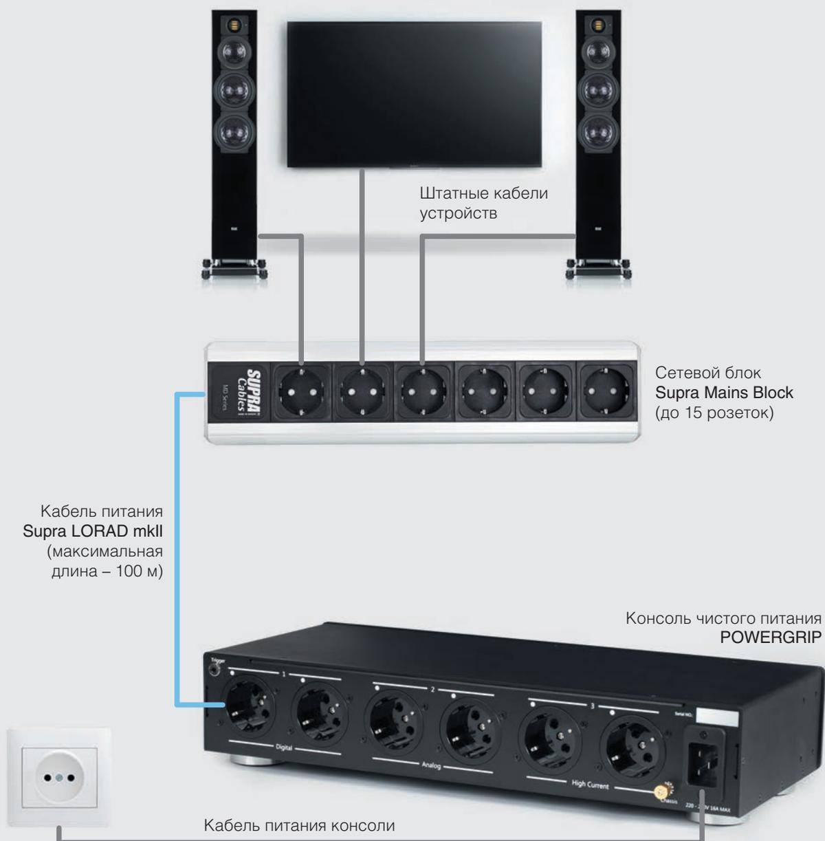
Питание от консоли POWERGRIP к сетевому блоку Supra подводится посредством фирменного экранированного кабеля Supra LoRad длиной от 1 до 100 м (приобретается отдельно), терминированного удобными разъёмами Supra. Таким образом, «чистая» энергия, полученная от POWERGRIP, не «загрязнится» в процессе доставки к удалённым аппаратам-потребителям.
